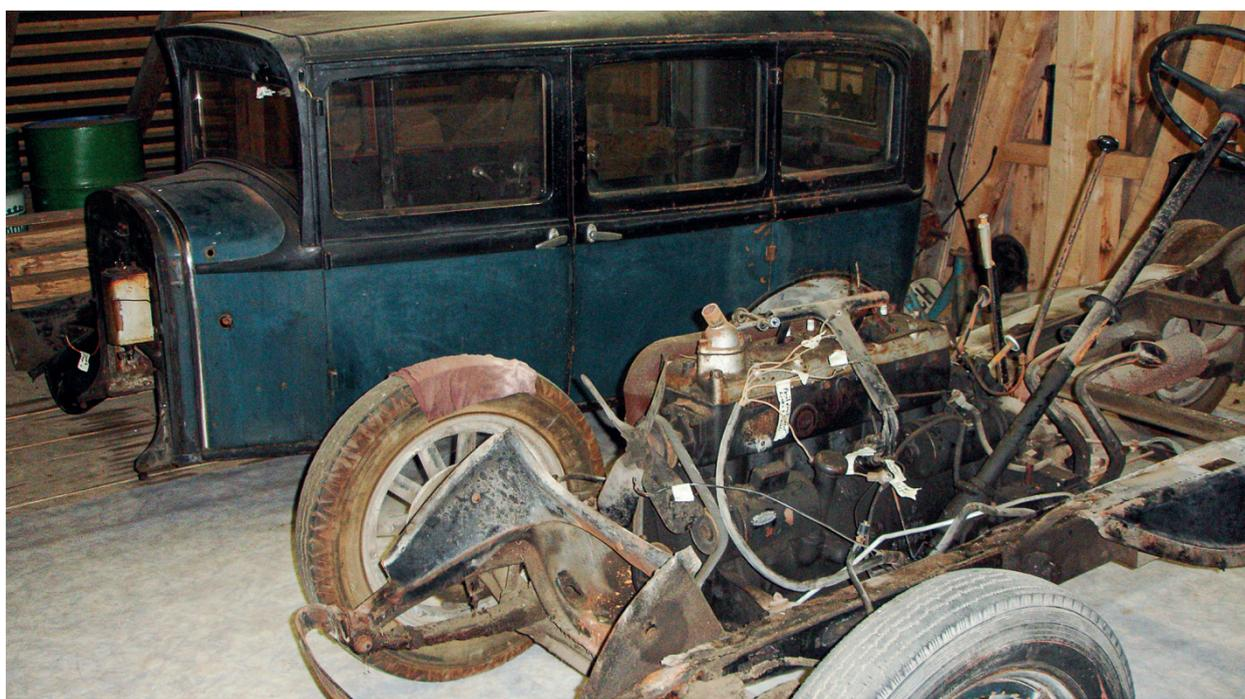
Ausgebautes Chassis mit Motor und dahinter das Führerhaus warten auf die Restauration.
